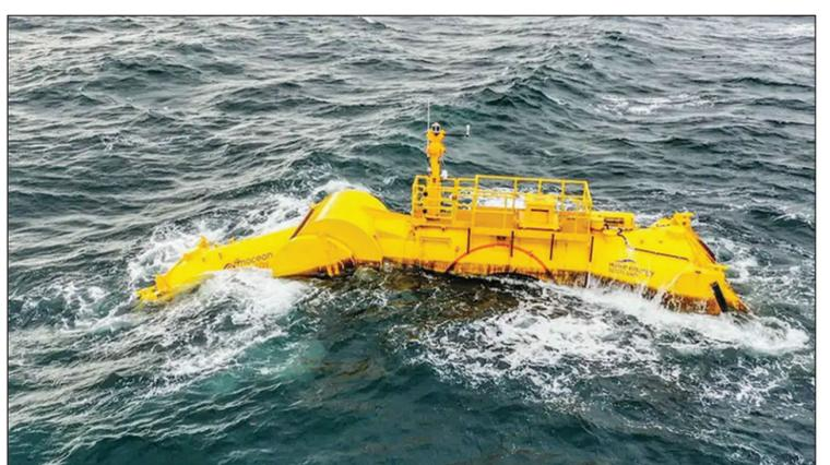
蘇格蘭公司Moccean讓大型浮動臂隨波浪彎曲，在中央鉸鏈處捕捉能量
